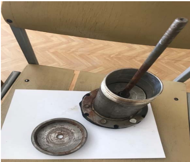
Рисунок 4 – Внешний вид опытного образца поршневого насоса.
