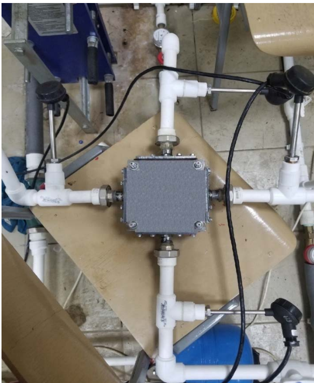
Рисунок 1 - Общий вид подключенного микроканального теплообменника
